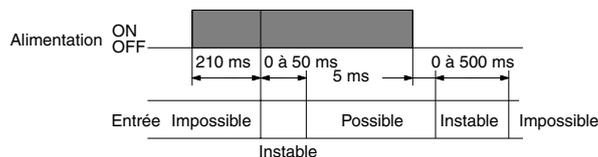
Procédez à la mise sous et hors tension à l'aide d'un relais d'une capacité nominale de 15 A minimum afin d'éviter toute détérioration des contacts causée par le courant d'appel de la mise sous et hors tension.
