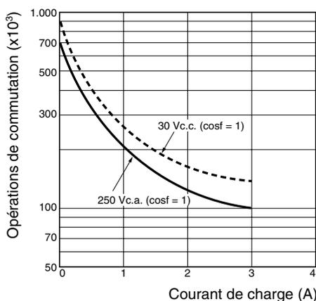
Référence : Un courant maximal de 0,15 A peut être commuté à 125 Vc.c. ( $\cos\phi = 1$ ) et un courant maximal de 0,1 A peut être commuté si L/R est de 7 ms. Dans les deux cas, une durée de vie de 100 000 opérations est prévisible. La charge minimale applicable est de 10 mA à 5 Vc.c. (niveau de défaillance : P).
