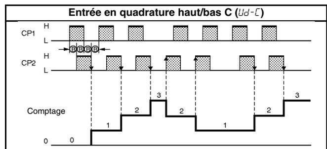
**Note :** 1. (A) indique la largeur minimale du signal et (B) exige au moins la moitié de la largeur minimale du signal. Si ces conditions ne sont pas remplies, une erreur de comptage (+1 ou -1) peut se produire.
