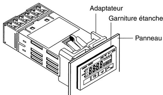
La surface du panneau du H8GN résiste à l'eau (conforme à NEMA 4X (à l'intérieur) et à IP66). Pour éviter que de l'eau ne s'infilte dans les circuits internes par l'interstice entre le compteur et le tableau de commande, posez une garniture en caoutchouc (fournie avec le H8GN) entre le compteur et le tableau et fixez-la solidement à l'aide de l'adaptateur pour montage encastré Y92F-34.
