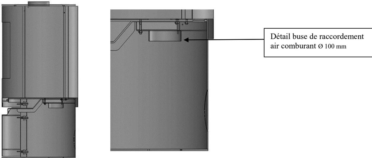
Ce poêle a été conçu pour être installé dans les maisons types BBC. Il est entièrement étanche et grâce à un raccordement (buse Ø 100 mm), il permet de prendre l'air de combustion directement à l'extérieur sans le prélever dans la pièce. Il est compatible avec les solutions de ventilation de type VMC double flux et hygro-réglable.
