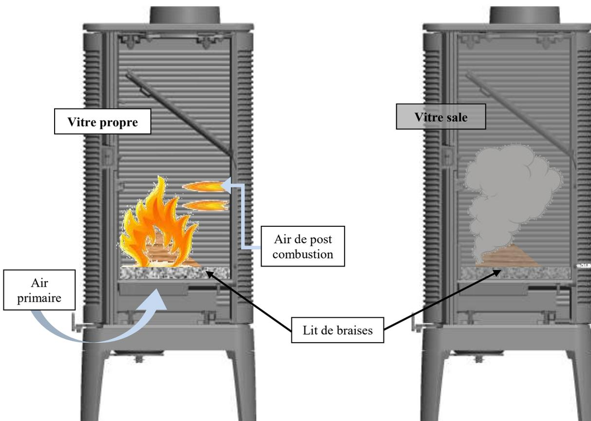
Schéma de « principe », non représentatif de l'appareil
