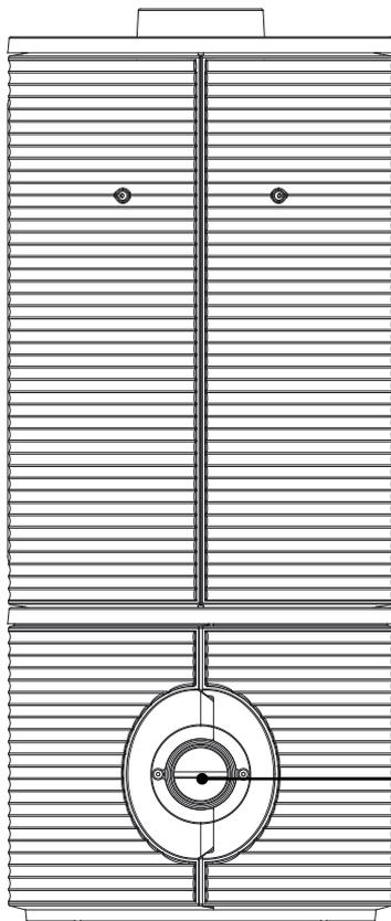
Ce poêle est équipé d'une buse Ø 80 permettant le raccordement de l'appareil à une arrivée d'air frais extérieur.
