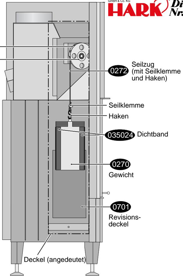
Seitenansicht auf das Gegengewicht der Feuerraumtür mit Einzelteilen der Mechanik (bei abgenommenen Deckel)
