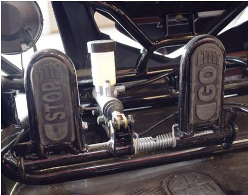
Vérifiez le niveau du liquide de freinage situé entre les pédales du conducteur avant chaque utilisation, même si vous recevez la machine montée.
