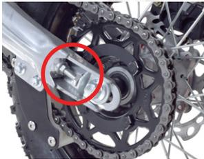
Desserrez les deux écrous qui maintiennent la roue. Serrez les boulons des tendeurs de chaîne du même nombre de tour de chaque côté pour reculer la roue et tendre la chaîne. Une fois le débattement souhaité obtenu, resserrez les écrous de la roue.
