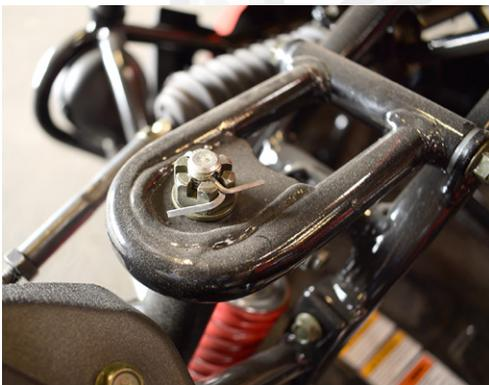
Vérifiez l'ensemble de la boulonnerie, même les parties fixées avec des goupilles. Les goupilles limitent le mouvement des écrous mais il peut quand même y avoir du jeu soit d'origine, soit au fur et à mesure de l'utilisation de la machine.
