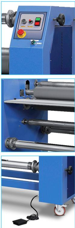
Lamineurs professionnels à chaud ou à froid conçus pour l'assemblage, la lamination et l'encapsulage des impressions grand format, mais aussi pour le contrecollage sur panneau ou encore l'application de *tape* ou d'adhésif double face. Le rouleau supérieur chauffant permet également la lamination à chaud de films de protection thermocollants à un coût inférieur à la lamination à froid.
