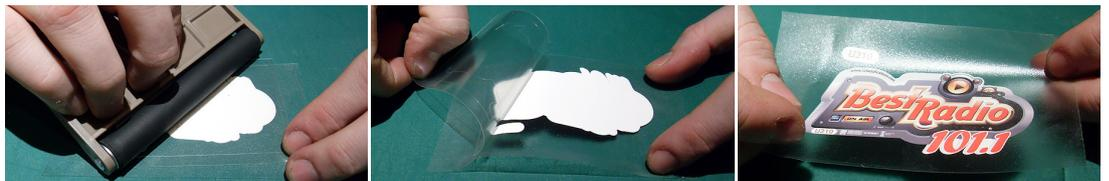
**PRESSE A CHAUD** 150-160°C | 15 à 20 secondes | Pression moyenne. *Tape* standard : recouvrir de papier sulfurisé.
