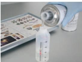
6. Versez en premier la résine dans le flacon doseur, puis le durcisseur, à parts égales (50/50). Utilisez pour cela les graduations visibles sur le flacon.
