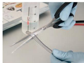
15. Avec des ciseaux, coupez des morceaux de tubes : 2 cm de tube transparent, 1 cm de tube noir et 1 cm de tube rouge.
