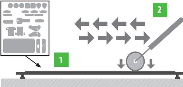
ASTUCE : pour éviter que la planche gondole, utilisez de la colle repositionnable en spray, des réglettes magnétiques ou de l'adhésif double face. Aplanissez ensuite au rouleau caoutchouc.
