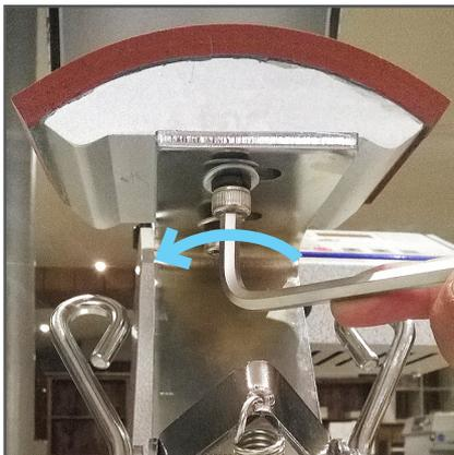
Dévissez les 2 vis de fixation du plateau inférieur à l'aide de la clé Allen (6 pans) appropriée.
