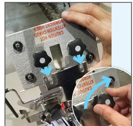
Insérez le plateau optionnel POCKET à la place du plateau pour casquettes et resserrez les deux molettes.
