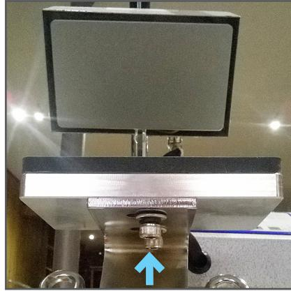
Positionnez le plateau inférieur et engagez les 2 vis et rondelles, sans les serrer pour l'instant.
