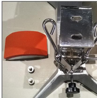
Retirez le plateau inférieur pour casquette. Les 2 vis avec rondelles serviront au remontage du plateau optionnel POCKET.
