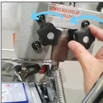
Desserrez les deux molettes de fixation du plateau supérieur. Inutile de les dévisser complètement : il suffit de les desserrer.
