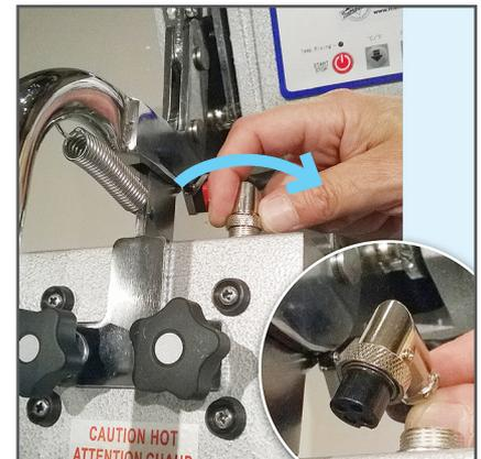
Dévissez et déconnectez la prise d'alimentation électrique du plateau supérieur chauffant. Attention : la prise d'alimentation au secteur doit être préalablement débranchée !
