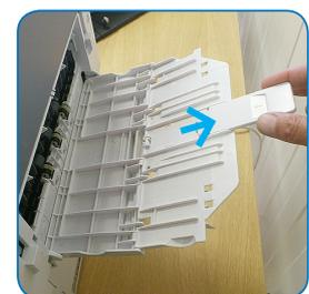
Poussez la languette bleue vers la gauche pour remonter la plaque en position haute. Ouvrez et déployez la sortie arrière pour un passage papier à plat. Lancez l'impression.
