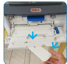
Ouvrez le bac multi-fonctions à l'avant de l'imprimante puis déployez les volets et la languette support papier.
