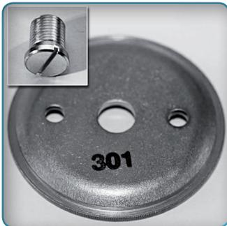
Après avoir démonté le mandrin, tenez-le à la main et tapez sur l'extrémité fileté de la vis avec le plat d'un marteau afin de l'extraire du mandrin.
