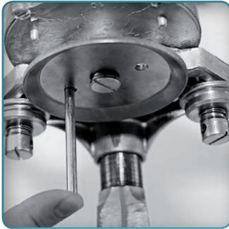
Insérez la tige de serrage dans l'un des 2 trous de la coupelle pour lui éviter de tourner, puis forcez sur la manivelle dans le sens anti-horaire pour débloquer la coupelle. Tournez ensuite la manivelle jusqu'à la position "0" puis dévissez manuellement la vis centrale.
