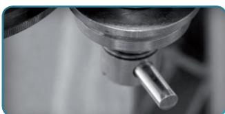
Finissez de resserrer la vis de galet à l'aide de la tige de serrage. Contrôlez que la cale d'écartement ne puisse pas se retirer manuellement. Si la cale se retire à la main, recommencez l'opération depuis le début.
