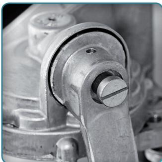
Une fois en position "0", insérez la manivelle dans l'orifice prévu à cet effet, poignée vers le bas et légèrement en avant.
