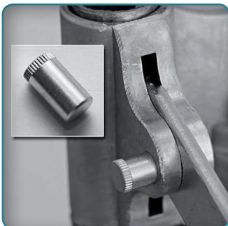
Insérez l'axe du levier dans le perçage, côté cannelé vers l'extérieur.
