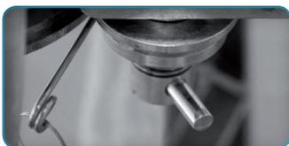
Insérez la cale d'écartement **LARGE** entre le mandrin et le galet primaire. Vissez la vis de butée jusqu'à ce qu'une résistance se fasse sentir sur la cale d'écartement et qu'elle commence à être entraînée vers l'avant. Serrez alors la vis de butée d'un quart de tour supplémentaire.
