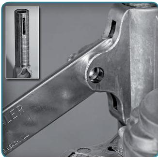
Le levier est utilisé pour lever et abaisser la tête de l'appareil lors des opérations de sertissage.
