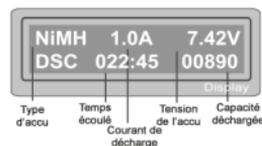
L'écran affiche l'état de la décharge. Vous pouvez appuyer sur le bouton Start/Enter pour modifier le courant de décharge. Appuyez à nouveau sur le bouton Start/Enter pour enregistrer la valeur. Appuyez sur le bouton Batt Type/Stop pour arrêter la décharge. Un signal sonore indique la fin de la décharge.
