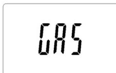
Le fonctionnement de l'émetteur est inhibé. Placez le manche au ralenti pour permettre à l'émetteur de poursuivre sa séquence d'initialisation et devenir pleinement opérationnel.
