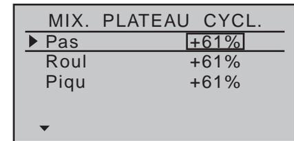
... respectivement à +61 %. Si le plateau cyclique ne devait pas suivre les déplacements des manches de commande, modifiez d'abord les sens de mixage de „+“ vers „-“, avant d'inverser le sens de rotation des servos dans le menu »Réglages servos«.
