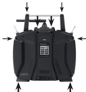
Maintenez les deux moitiés de boîtier ensemble, puis retournez l'émetteur et laissez simplement tomber les vis sur une table ou sur un support adéquat. Retirez maintenant avec soin le fond du boîtier en l'ouvrant vers le bas, comme si vous ouvriez un livre.
