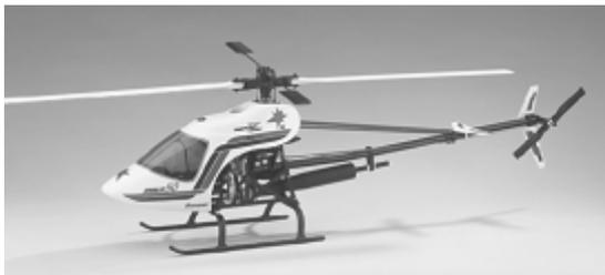
Comme exemple, nous utiliserons l'hélicoptère STAR-LET 50 *Graupner*, avec une commande de plateau à 3 points répartis à 120° de type „3Sv(2 latér.)“, rotor tournant dans le sens horaire, réglage débutant, avec courbe des gaz „douce“, sans gyroscope en mode Heading-lock, sans intervention gyroscopique coté émetteur et sans régulateur comme en mode d'utilisation „normale“.
