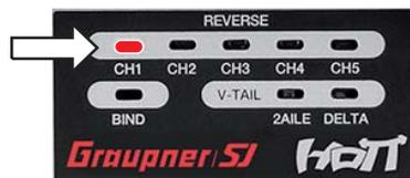
L'affichage par LEDs disparaît au bout de 5 secondes, après avoir quitté le menu Inversion du sens de rotation des servos et également avant toute nouvelle mise en route de l'émetteur.
