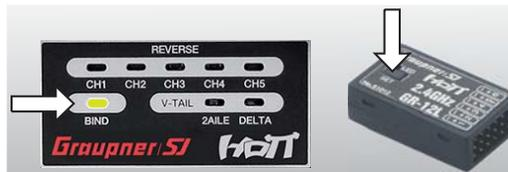
Si par contre, la LED rouge du récepteur GR-12L reste allumée ou si la LED BIND jaune de l'émetteur ne s'allume pas, la procédure Binding a échouée. Modifiez les positions des antennes et relancer toute la procédure.
