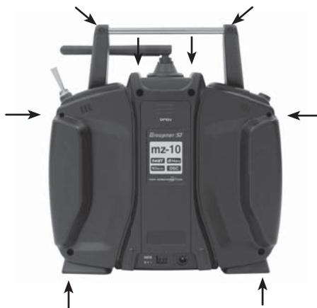
Maintenez les deux moitiés de boîtier ensemble avec la main, puis retournez l'émetteur et laissez simplement tomber les huit vis sur une table ou sur un support adéquat. Retirez maintenant avec soin le couvercle du boîtier en le rabattant vers le bas.
