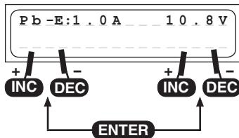
Questo programma serve per es. per determinare la capacità residua di un accumulatore di alimentazione di un motore. Con questo programma la scarica viene effettuata con la corrente di scarica impostata (0.1...5.0 A, a sinistra sul display) fino al raggiungimento della tensione finale di scarica impostata (1.7...12.0 V a destra sul display).
