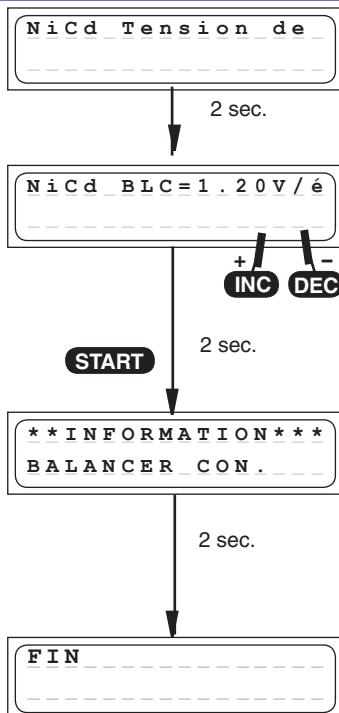
Ce programme sert pour la coordination de la tension des différents éléments pour les packs d'accus de 2-8 éléments. Placer la tension de fin de décharge du Balancer 1.20...1.30 V avec la touche INC ou DEC.
