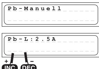
Con questo programma si può impostare, prima di collegare l'accumulatore, con i tasti INC / DEC, la massima corrente di carica ammessa (corrente di carica massima).
