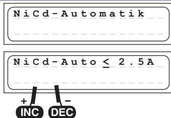
In questo programma il caricabatterie riconosce il tipo di accumulatore collegato e adegua la corrente di carica corretta, in modo da evitare un sovraccarico dell'accumulatore. La corrente di carica massima può essere impostata con i tasti INC / DEC prima di collegare l'accumulatore da 0.1 a 10.0 A senza limitazioni.
