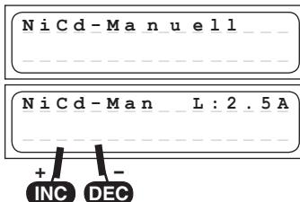
Bei diesem Programm wird der Akku mit dem eingestellten Ladestrom aufgeladen.
