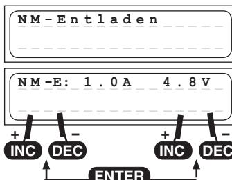
Questo programma è utile per es. per determinare la capacità residua oppure per la scarica dell'accumulatore di una trasmittente, di una ricevente o di alimentazione di un motore. Con questo programma viene effettuata la scarica con una corrente di scarica impostata (0.1 ... 5.0 A, a sinistra sul display) fino alla tensione finale di scarica (0.1 ... 16.8 V, a destra sul display).
