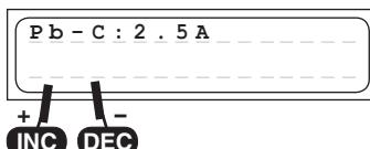
Si le fabricant de l'accu indique un plus faible courant de charge, celui-ci devra aussi être limité, car autrement le chargeur pourrait régler un plus haut courant en raison d'une bonne docilité de charge de l'accu.
