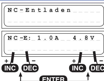
Dieses Programm dient z.B. zur Feststellung der Restkapazität oder zur definierten Entladung eines Sender-, Empfänger oder Antriebsakkus
