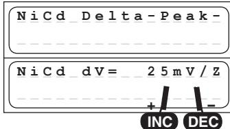
Die Ladeabschaltautomatik (Akku-Vollerkennung) arbeitet nach dem millionenfach bewährten Delta-Peak-Verfahren (auch bekannt als Delta-U- oder Delta-V-Verfahren). Dieses Verfahren wertet das Spannungsmaximum der Ladekurve aus, welches recht genau das Erreichen des maximalen Ladungsinhaltes angibt.
