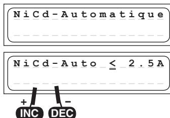
Dans ce programme, le chargeur détecte le type d'accu NiCd connecté et adapte le courant de charge en correspondance, de sorte qu'une surcharge du pack d'accus sera empêchée.
