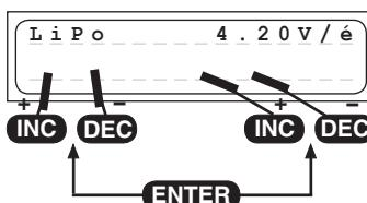
C'est le programme de réglage le plus important pour les accus au Lithium. Le type d'accu sera déterminé dans cette sélection. Celui-ci sera soigneusement réglé et vérifié, car le chargeur travaille sur tous les autres paramètres de charge pour ces réglages. Le réglage des types d'accus (LiPo, Lilo ou LiFe) influence la tension de coupure. Si un accu au Lithium n'est rechargé qu'au 2/3 de sa capacité, c'est qu'un mauvais type d'accu a été réglé.
