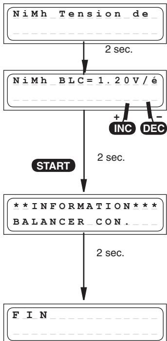
Ce programme sert pour la coordination de la tension des différents éléments pour les packs d'accus de 2-8 éléments. Placer la tension de fin de décharge du Balanceur 1.20...1.30 V avec la touche INC ou DEC.
