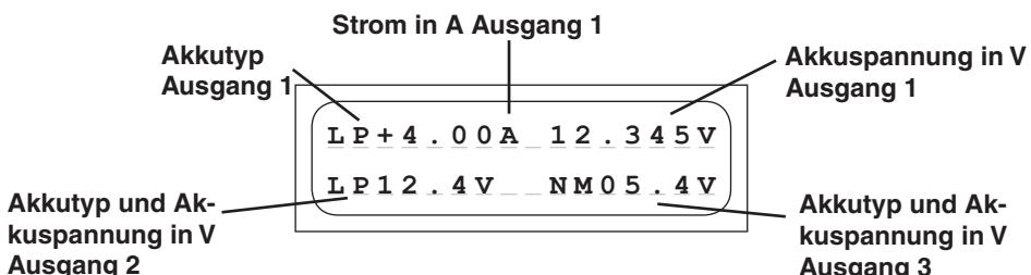
Die während der Ladung /Entladung wichtigen Daten werden übersichtlich auf der zweizeiligen Flüssigkristallanzeige wiedergegeben und sind bis zum Abklemmen des zu ladenden Akkus sichtbar. Wird ein weiterer Akku geladen sind die vorher angezeigten Werte nicht mehr abrufbar.
