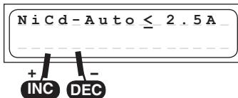
In diesem Programm erkennt das Ladegerät den angeschlossenen Ni-Cd Akkutypen und passt den Ladestrom dementsprechend an, sodass eine Überlastung des Akkupacks verhindert wird.
