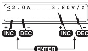
Dieses Programm dient dazu, die Akkus auf den bestmöglichen lagerfähigen Ladezustand zu laden oder entladen.
