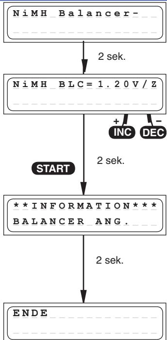
Dieses Programm dient zur Angleichung der Zellenspannungen der einzelnen Akkuzellen für Akkupacks mit 2-8 Zellen.
