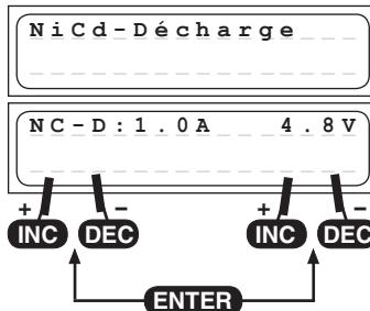
Ce programme sert par ex. pour déterminer la capacité restante ou pour définir la décharge d'un accu d'émission, de réception ou de propulsion.
