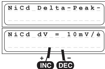
La coupure de charge automatique (Détection pleine charge de l'accu) travaille selon le procédé Delta-Peak des millions de fois éprouvé (appelé aussi Delta-U ou Delta-V). Ces procédés valorisent la tension maximum de la courbe de charge, laquelle calcule exactement l'atteinte de la charge maximale.
