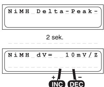
Die Ansprechspannung (in mV pro Zelle!) der Abschaltautomatik für NiMH-Akkus kann eingestellt werden. NiMH-Akkus haben gegenüber NiCd-Akkus einen weniger ausgeprägten Spannungsabfall. Als praktikabel haben sich Spannungseinstellungen von 5 ... 25mV/Zelle herausgestellt. Höhere Spannungen führen häufig zur Überladung der Batterie, niedrigere Spannungen führen oft zu Frühabschaltung.
