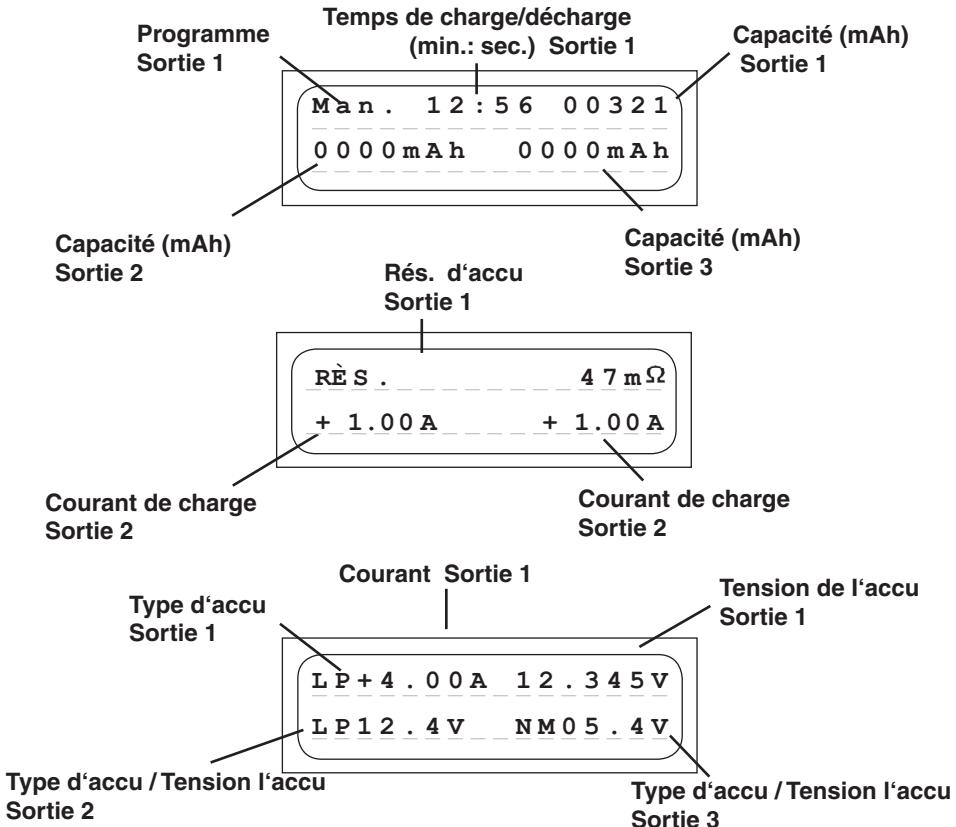
Durant la charge/décharge, des données importantes seront clairement lisibles sur l'affichage à cristaux liquides à deux lignes jusqu'à la dé connexion de l'accu. Avec la charge d'un autre accu, les valeurs précédemment affichées ne seront plus apppellables.
