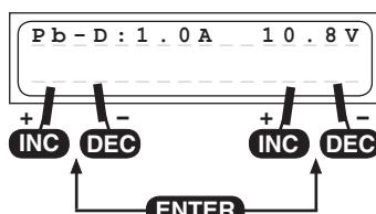
Ce programme sert par ex. pour déterminer la capacité restante d'un accu de propulsion.
