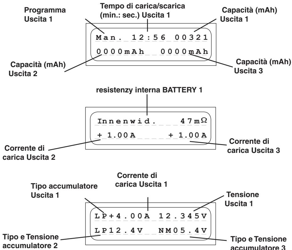
I dati essenziali relativi alla carica e scarica vengono visualizzati chiaramente sulle due righe del display a cristalli liquidi e sono mantenuti fino allo scollegamento dell'accumulatore. Quando viene collegato un altro accumulatore i valori precedenti non sono più richiamabili.
