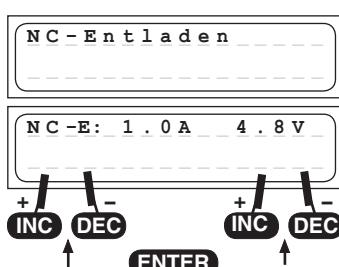
Questo programma serve per es. per determinare la capacità residua o per scaricare ad un determinato livello l'accumulatore di una trasmittente, di una ricevente o di alimentazione di un motore.
