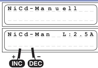
Con questo programma potete caricare il vostro accumulatore con la corrente impostata. La corrente massima può essere impostata prima di collegare l'accumulatore con i tasti INC / DEC da 0.1 a 10.0 A.
