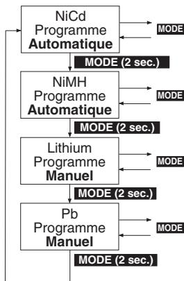
Les possibilités de charge et de décharge de l'ULTRA TRIO PLUS 16 sont clairement et logiquement réparties dans les quatre groupes de programmes. Un groupe de programmes propre à chacun des différents types d'accu NiCd, NiMH, LiPo/LiPo/LiFe et Pb (Plomb) est à disposition. Un autre groupe de programmes permet des possibilités de réglage Programme individuelles du chargeur.
