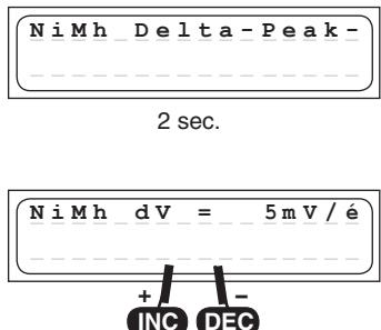
La tension d'intervention (en mV par élément) de la coupure automatique pour les accus NiMH pourra être réglée.
