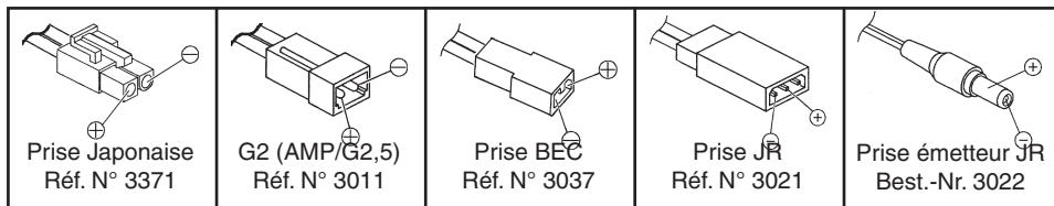
Utiliser uniquement des cordons de charge originaux avec des fils d'une section suffisante.
