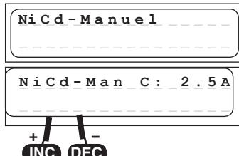
Avec ce programme, l'accu sera chargé avec le courant de charge réglé.
