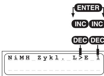
Questo programma serve per ottimizzare la capacità e la formattazione di un accumulatore. In alto a destra sul display impostate, con i tasti INC / DEC se il programma di formattazione deve iniziare con la carica o la scarica. Quindi impostate il numero di cicli da 1 a 5 (per es. impostando 3 cicli, l'accumulatore viene caricato e scaricato tre volte).
