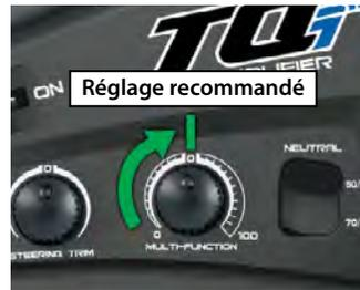
Tournez le bouton dans le sens des aiguilles d'une montre pour augmenter l'assistance; tournez-le dans le sens contraire pour réduire l'assistance. Tournez complètement le bouton dans le sens contraire des aiguilles d'une montre jusqu'à l'arrêt pour éteindre la TSM.
