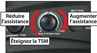
**Note :** La TSM se désactive automatiquement lors du pilotage ou du freinage en marche arrière.
