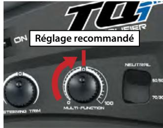
Tournez le bouton dans le sens des aiguilles d'une montre pour augmenter l'assistance; tournez-le dans le sens contraire pour réduire l'assistance. Tournez complètement le bouton dans le sens contraire des aiguilles d'une montre jusqu'à l'arrêt pour éteindre la TSM.
