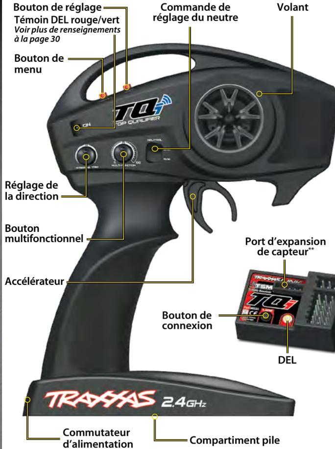
\*\* Port de capteur accessoire à utiliser avec l'extenseur de télémetrie (voir plus de renseignements sur Traxxas.com et dans les matériels fournis)
