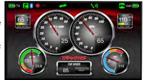
Le tableau de bord personnalisable de Traxxas Link affiche en temps réel les rpm, la vitesse, la température et la tension.
