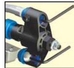
Les pivots à rotule de la suspension situés dans les supports d'essieu régulent le carrossage statique. Les pivots à rotule sont protégés par des bouchons à chaînette bleus. Pour régler le carrossage statique, passez la clé hexa de 2,5mm dans la fente du bouchon à chaînette et agrippez le bout du pivot à rotule (si la suspension est comprimée jusqu'à ce que les bras en soient parallèles à la terre, l'agrippage à l'aide de la clé
