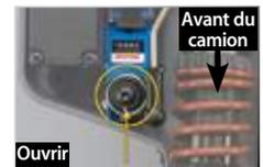
**Différentiel verrouillé :** Allumez le récepteur et le transmetteur. Mettez le commutateur T-Lock à la position inférieure pour verrouiller le différentiel arrière. Confirmez que l'arbre de sortie du servo tourne dans le sens contraire des aiguilles d'une montre pour pivoter le palonnier de servo à la position montrée, la fente du ressort perpendiculaire sur la tringlerie et le levier coudé éloigné du servo.
