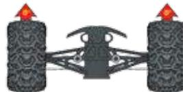
être parfaitement droites. Si les roues virent légèrement, ajustez légèrement la commande du transmetteur réglant la direction jusqu'à ce qu'elles soient en position droite vers l'avant.
