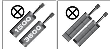
Ne mélangez pas les capacités des piles. Utilisez deux piles avec la même capacité.
