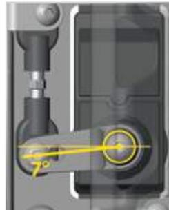
Au besoin, réglez finement la longueur de la deuxième biellette pour éliminer toute charge du système de direction dans la position neutre. Si vous utilisez des servos du marché des pièces de rechange, il est important d'utiliser les palonniers de servo conçus pour le Summit. Des palonniers de servodirection optionnels sont vendus séparément pour les servos non-Traxxas.
