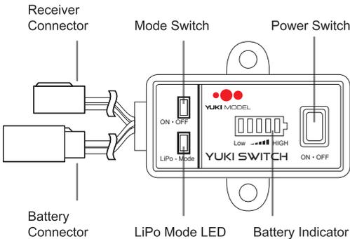
Diese Funktion verhindert die Tiefentladung bei einem 2S-LiPo. Um den Akku zu schützen, wird die Leistungsabgabe unter 6 V sofort abgeschaltet und wieder zugelassen, sobald die Spannung wieder über 6 V steigt.
