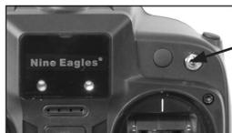
**Fonction de commande étendue :** Disposer l'interrupteur à bascule sur l'émetteur en haut à droite vers le haut. Le point "affichage d'état Dual-Rate" est présenté intégralement.
