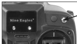
**Fonction de commande réduite :** Disposer l'interrupteur à bascule sur l'émetteur en haut à droite vers le bas. Le point "affichage d'état Dual-Rate" est réduit de moitié.
