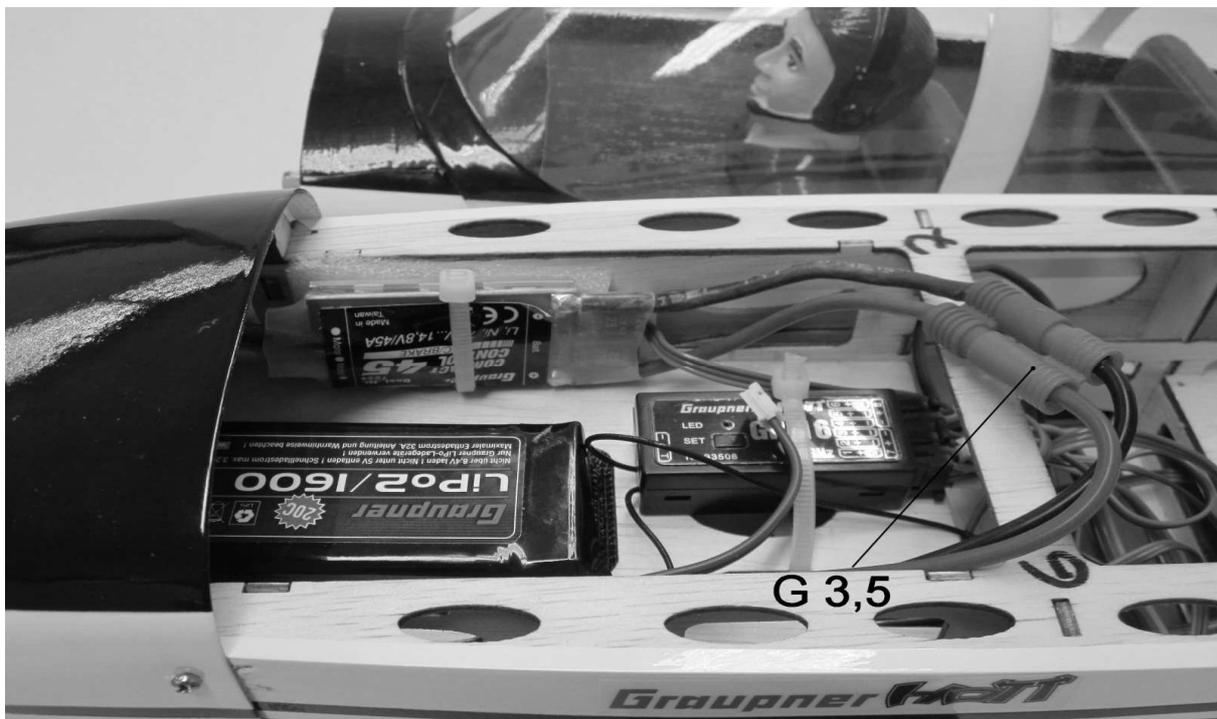
Die Abbildung zeigt den Rumpffinnenraum bei abgenommener Kabinenhaube. Beachten Sie, dass mit dem Schließen der G 3,5-Steckverbindung, wie in der Abbildung zu sehen ist, die Empfangsanlage eingeschaltet wird.
