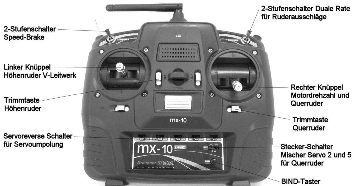
Die Abbildung zeigt den konfigurierten Sender, der **rechte Knüppel** ist auf die „Motor-Aus“ Position nach hinten gezogen, der **Stecker-Schalter** ist ganz links eingesteckt, sodass Servo 2 und 5 für die Querruderfunktion gemischt sind. Bitte beachten Sie, dass die „Speed-Brake“-Funktion nur mit einem programmierten
