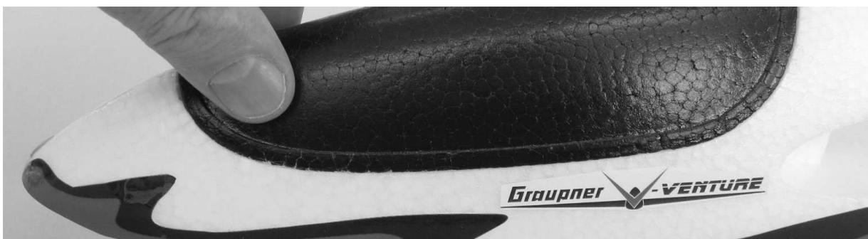
Zum Öffnen der Kabinenhaube diese an der Vorderseite seitlich festhalten und nach oben abziehen. Dieser Vorgang erfordert einen relativ hohen Kraftaufwand da die Haltekraft des Magnetverschlusses so eingestellt ist, dass die Kabinenhaube auch bei Kunstflugfiguren absolut sicher und fest sitzt. Nach dem Abnehmen der Kabinenhaube werden die beiden Tragflächenhälften in den Rumpf eingeschoben, dazu die Servokabel durch die entsprechende Öffnung im Rumpf nach vorne herausführen.
