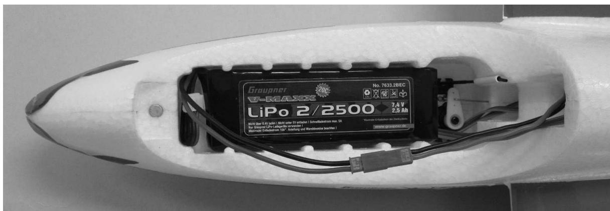
Die Abbildung zeigt die fertig eingesetzte LiPo-Batterie 2/2500 7,4 V. Nach dem Aufsetzen der Kabinenhaube ist der **V-VENTURE** flugfertig.
