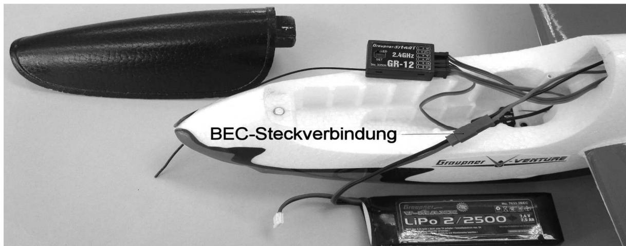
Die Abbildung zeigt den fertig angeschlossenen Empfänger und die geschlossene BEC-Steckverbindung. Bitte beachten Sie dazu die Hinweise des folgenden Kapitels.
