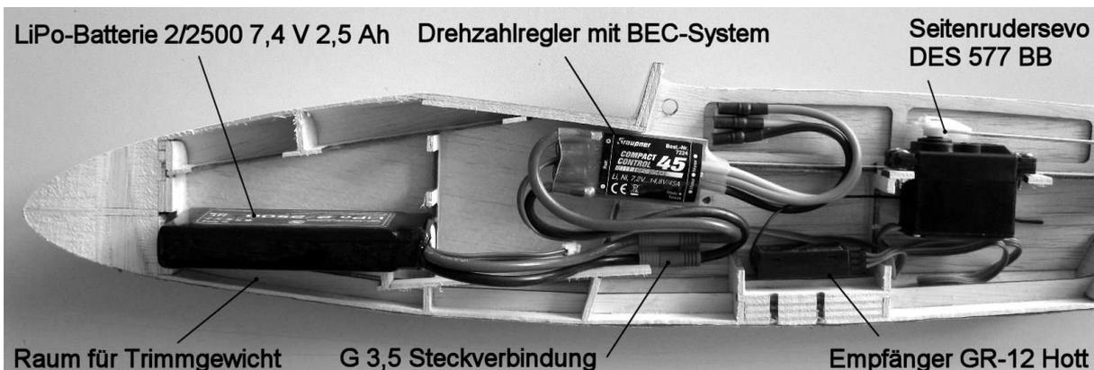
La vue montre l'emplacement dans le fuselage des différents éléments en version
