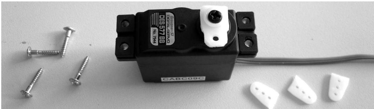
La vue montre le servo de commande de la profondeur prêt à être monté, montez les douilles laiton dans les silentblocs caoutchouc par le dessous. Coupez les bras non utilisés du palonnier. Repercez le trou de fixation du palonnier au Ø 1,9 mm.
