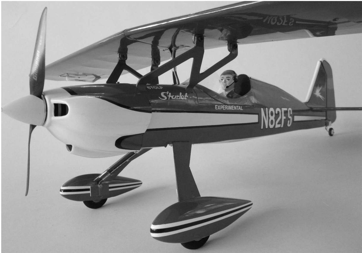
La vue représente le train d'atterrissage complet et aile montée avec les 4 vis M3x6. Pilote et pare-brise sont également collés.
