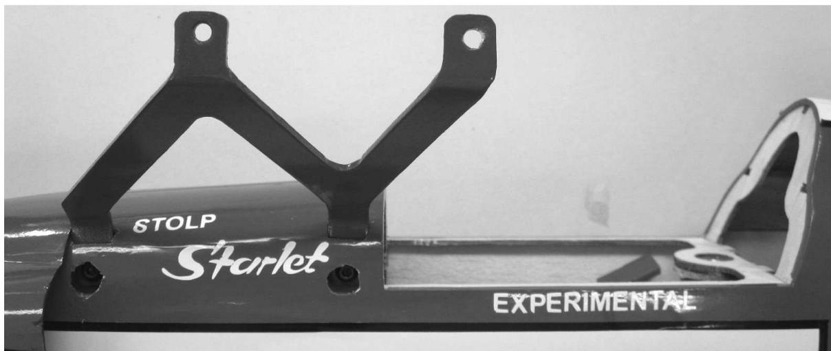
Les ouvertures pour la fixation du support de l'aile sont sous l'entoilage et il faut repérer leur emplacement par tâtonnement, puis couper l'entoilage avec un cutter à balsa. Fixez le support sur le fuselage avec les vis CHc M3x8. Par la suite, ces ouvertures seront masquées avec la bande de décoration jointe.
