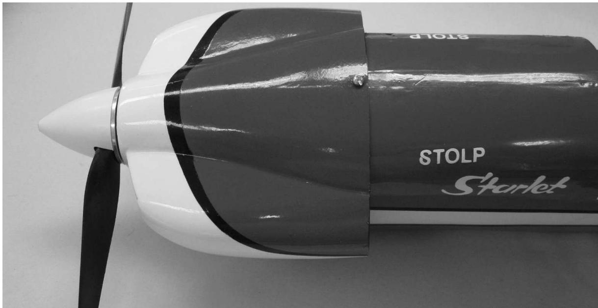
Si tout est correct, fixez le capot moteur avec les 3 vis Ø 2,2x 6,5 mm, et percez le capot à Ø 2,2 mm. La position des deux vis de fixation du capot est visible sur les photos de l'étape de montage du train d'atterrissage.
