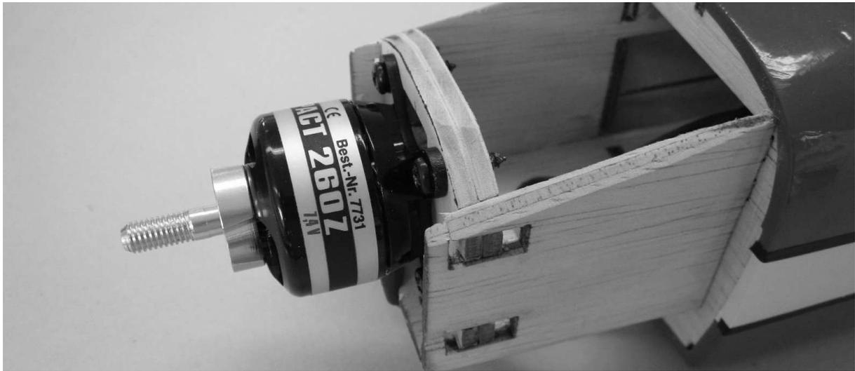
Fixez le moteur avec les 4 vis Ø 3x10 mm livrées avec le moteur, en respectant le marquage sur le couple moteur. Montez le capot et la flasque du cône. Ajustez maintenant le moteur avec son support ajustable de manière à ce que le cône et le capot soient dans le même prolongement..
