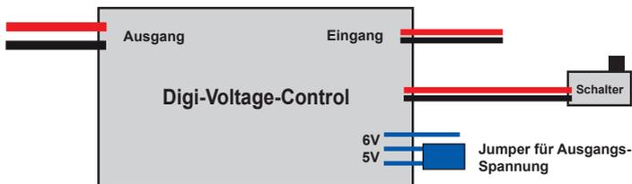
**WICHTIGER HINWEIS:** Das Digital BEC erzeugt ein elektromagnetisches Feld. Montieren Sie das BEC mindestens 5 cm oder mehr vom Empfänger entfernt im Modell!
