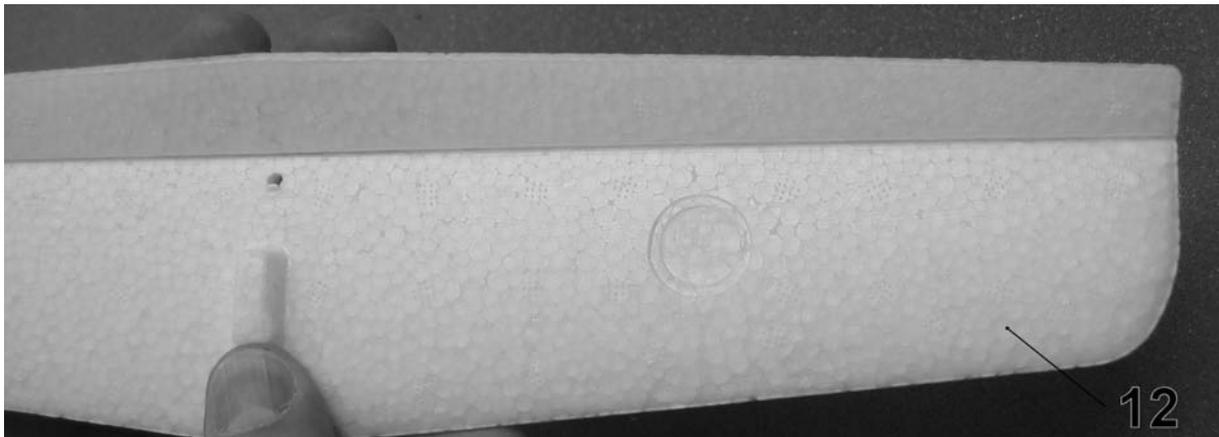
Das Höhenruder vom Höhenleitwerk (12) so lange bis zum Anschlag auf und ab biegen, bis das Ruder sich leichtgängig bewegen lässt. Das Höhenleitwerk exakt ausgerichtet auf den Rumpf kleben. Durch Anvisieren von vorne und oben überprüfen.
