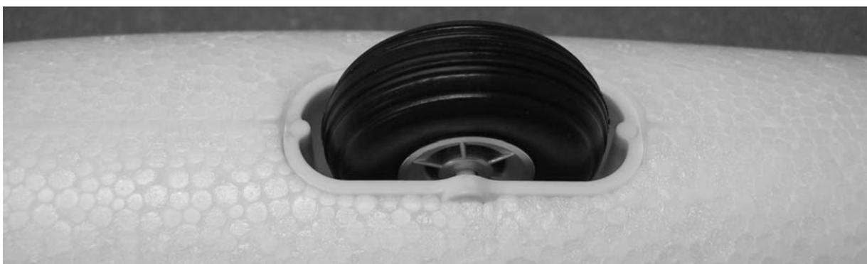
Der fertig in den Rumpf eingeklebte Radkasten.
