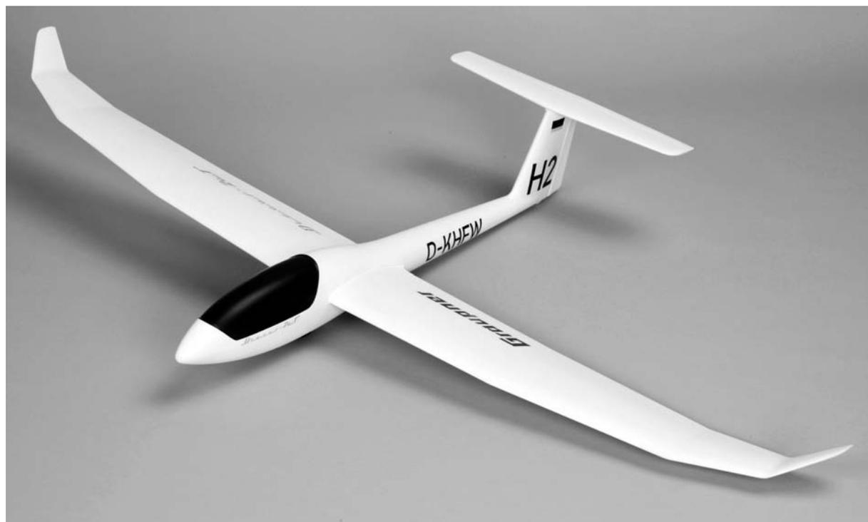
**Für Segelflug oder Elektroantrieb mit 2 LiPo- Zellen ab 800 mAh**
