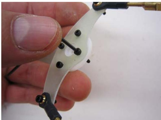
Den Seitenruderservoarm (35) auf die Servoscheibe auflegen und mit den Schrauben (30) und den Stopmuttern (31) auf der Servoscheibe montieren.
