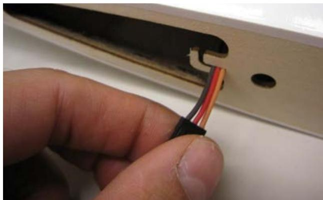
Schieben Sie von der Rumpffinnenseite aus die Buchse in die Rumpfsseitenwand und verkleben diese mit zähflüssigem Sekundenkleber bündig mit der Rumpfaussenwand.
