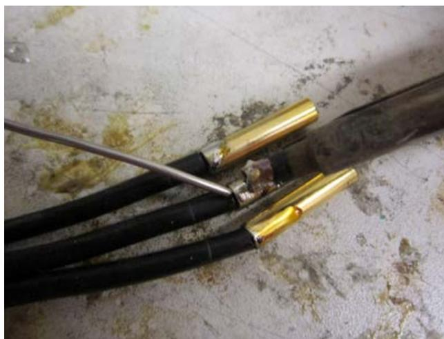
Schieben Sie die Schrumpfschläuche die dem Motor beiliegen auf die Stecker und über die Kabel auf und schrumpfen Sie die Kabel mit den Steckern und mit Hilfe eines Heißluftföhns ein.
