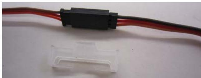
Schieben Sie den Sicherungsklipp über die zusammengesteckten Kunststoffteile.
