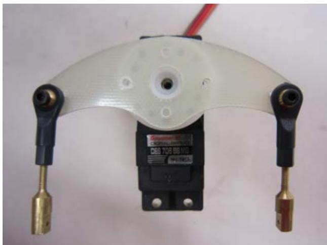
Bohren Sie die 4 Befestigungslöcher auf die Servoscheibe ab.
