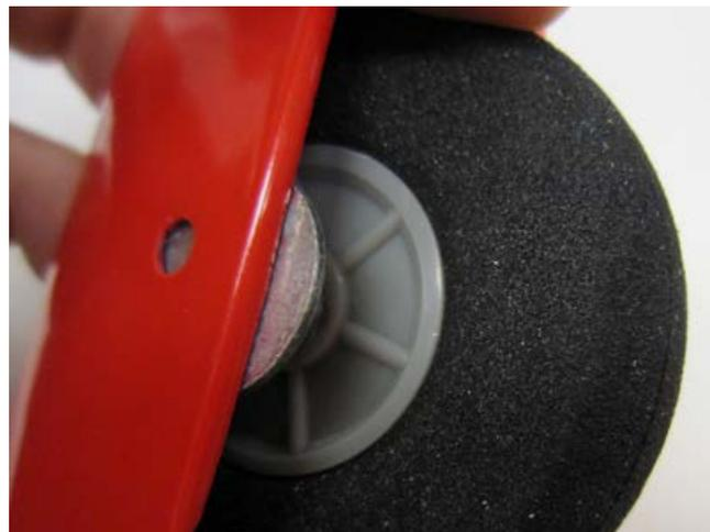
Drehen Sie die Schraube vollständig in die Stopmutter (27) ein, so dass sich das Rad (26) noch drehen lässt. Der Kopf der Schraube sollte jetzt in der vergrößerten Bohrung der Radverkleidung (22, 23) sitzen.
