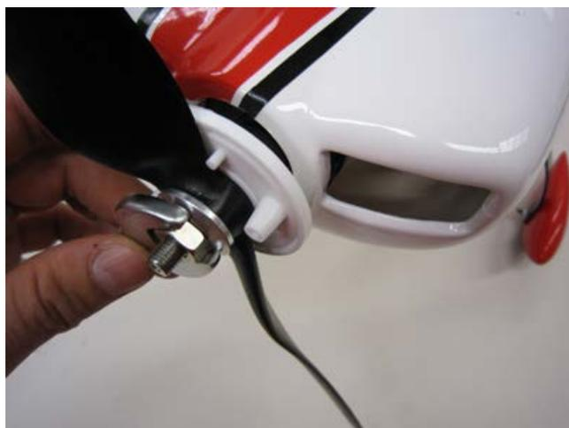
Schneiden Sie die Spinnerkappe an der Öffnung für den Propeller passend für das verwendete Propellerblatt aus.
