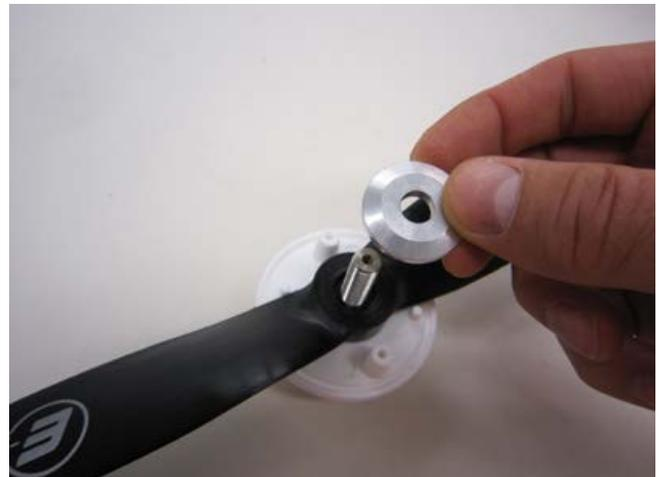
Drehen Sie die Mutter auf den Spannkonus auf, aber ziehen diese nicht fest, da sonst der Spannkonus zugezogen wird und nicht mehr auf die Welle des Motors passt
