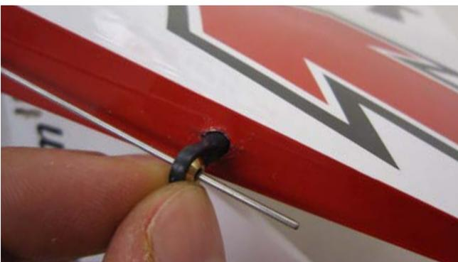
Kleben Sie den Kugelgelenkträger (19) in das Seitenruder (7) mit zähflüssigem Sekundenkleber ein.
