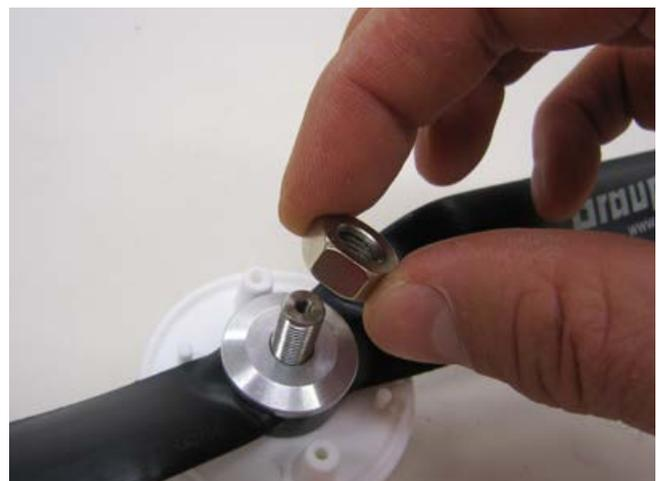
Schieben Sie die Einheit auf die Welle des Motors auf, aber nur so weit, dass Sie ca. 2 mm Abstand zum Motorgehäuse haben wo die Welle in den Motor eintritt.
