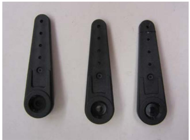
Mit einem Seitenschneider die Servoarme auf Höhe der ersten Bohrung abtrennen und im Radius um die zweite Bohrung mit einem Schleifklotz verrunden.
