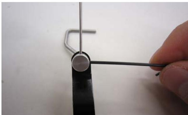
Schieben Sie den Stelling (13) den sie als erstes aufgeschoben haben bis zum Anschlag an den Spornradbügel (15) und ziehen die Madenschraube (12) fest.
