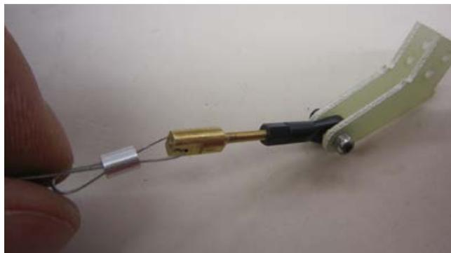
Pressen Sie die Quetschhülse (36) mit einer Zange fest zusammen, so dass das Anlenkseil (37) nicht mehr herausrutschen kann.
