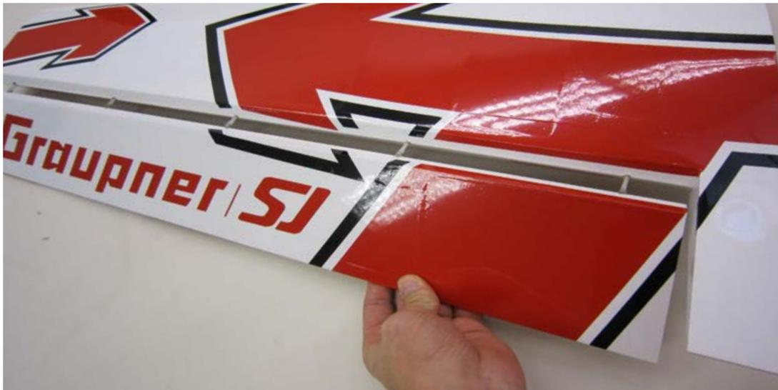
Schieben Sie das Ruder bis an die Drehachse der Scharniere. Durch mehrmaliges Bewegen der Ruder auf Vollausschlag werden die Stiftscharniere in die richtige Position gebracht.
