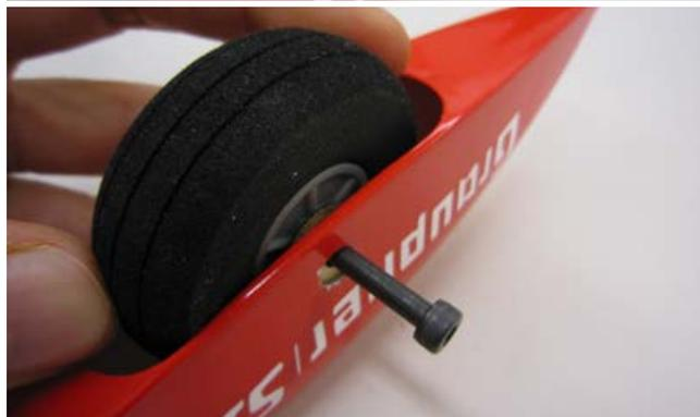
Drehen Sie die Stopmutter (27) auf die Schraube (24) bis die Schraube (24) ca. 2 mm aus der Stopmutter (27) übersteht.
