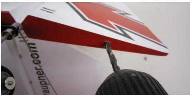
Schieben Sie den Kugelgelenkträger (19) auf die Spornradanlenkung (16) auf und in das Seitenruder (7) ein.
