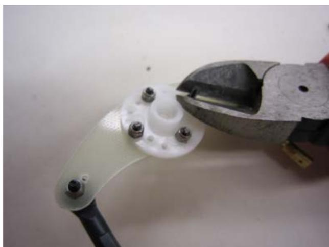
Die abgetrennten Schraubenenden mit einer Feile mit den Stopmuttern (31) bündig versäubern.
