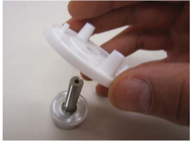
Schieben Sie die Luftschraube auf die Welle des Spannkonus auf.
