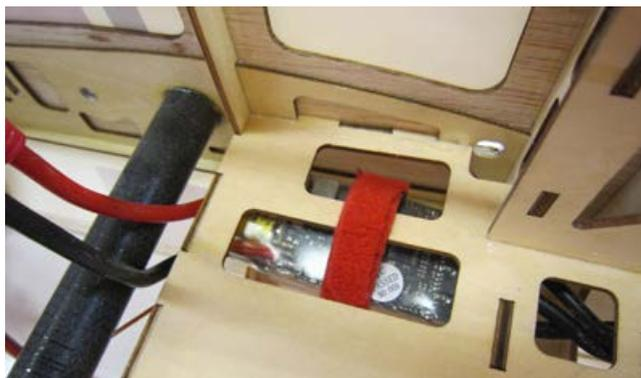
Stecken Sie die Anschlusskabel des Reglers in den Empfänger ein, gehen Sie hier vor wie in der Anleitung des Empfängers und des Reglers beschrieben.
