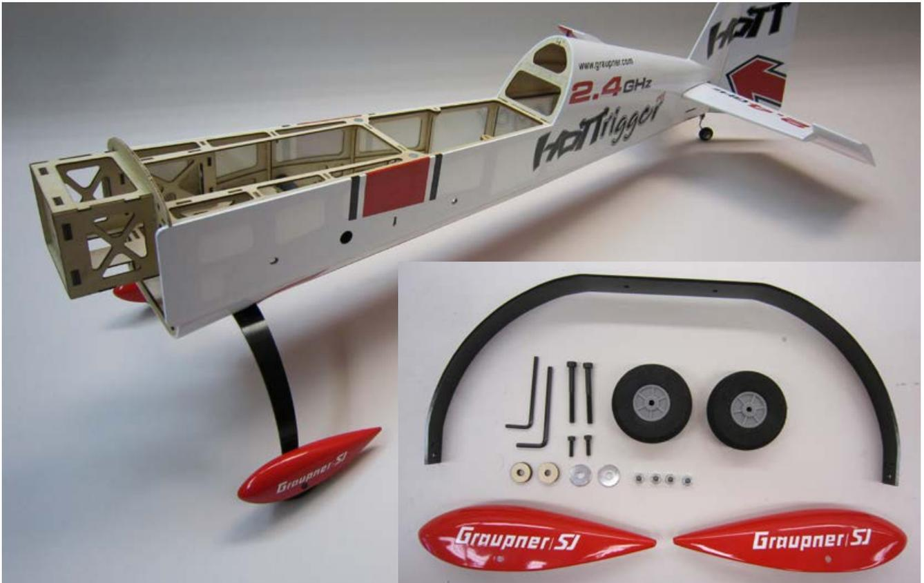
Den Hauptfahrwerksbügel (20) in die Fahrwerksaussparung legen und mit den Schrauben (21) montieren.
