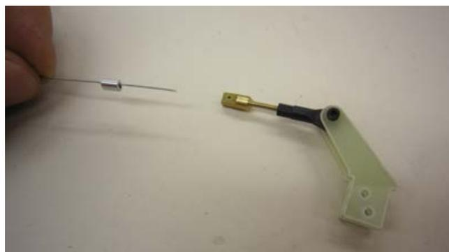
Führen Sie das Anlenkseil (37) in die Bohrung der Augenschraube (34).
