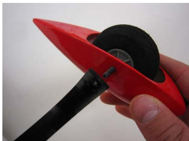
Drehen Sie eine weitere Stopmutter (27) auf die Schraube auf um die Radverkleidung (22, 23) mit der Schraube am Hauptfahrwerksbügel (20) zu befestigen. Kontern Sie die beiden Stopmutter (27) gegeneinander.
