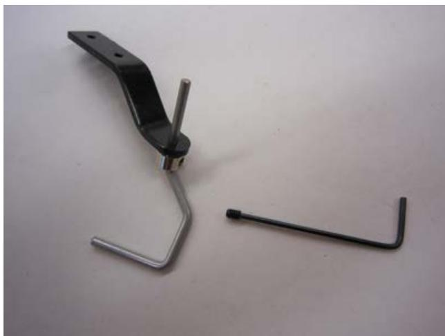
Entfernen Sie die Madenschraube (12) aus der Spornradanlenkung (16) und schieben die Spornradanlenkung (16) auf den Spornraddraht (14) auf.
