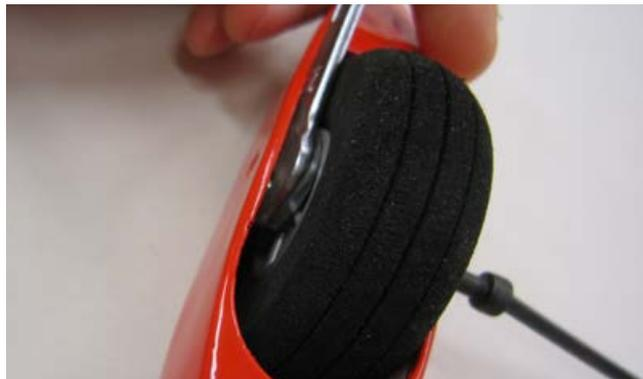
Schieben Sie die Unterlagsscheibe (28) auf den Überstand der Schraube
