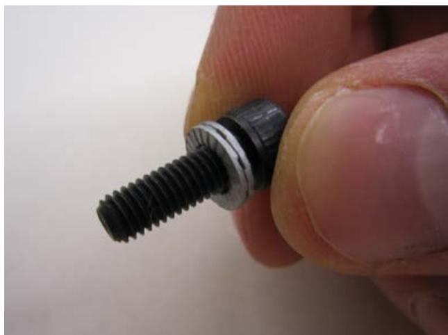
Montieren Sie die Stehbolzen am Montagekreuz.
