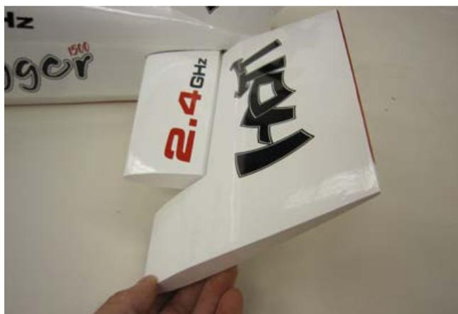
Sichern Sie die Höhenruder (5 und 6) mit Kreppklebeband gegen Verrutschen, Schieben Sie dann mit Hilfe eines Schraubendrehers den Höhenruderverbinder bis zum Anschlag in die Höhenruder (5 oder 6) ein. Mit einem Küchentuch und etwas Spiritus überflüssigen Klebstoff entfernen.
