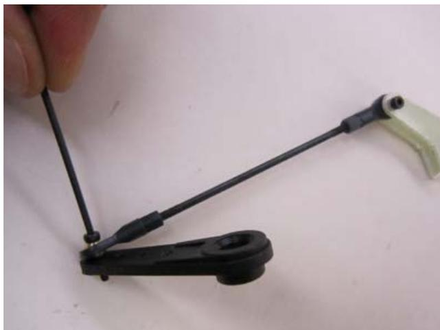
Ziehen Sie die Schraube (30) mit der Stopmutter (31) fest.
