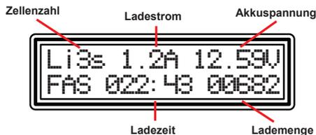
6. Wenn der Ladevorgang abgeschlossen ist, ertönt ein akustisches Signal. Ein vorzeitiges Abbrechen des Ladevorgangs, kann durch Drücken der BATT. TYPE Taste erreicht werden.
