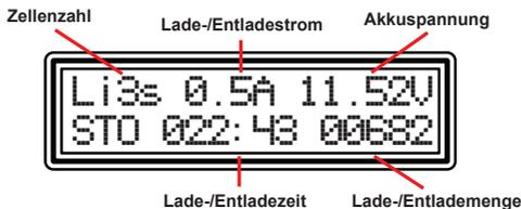
4. Wenn der Vorgang abgeschlossen ist, ertönt ein akustisches Signal. Ein vorzeitiges Abbrechen des Vorgangs, kann durch Drücken der BATT. TYPE Taste erreicht werden.
