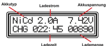
4. Wenn der Ladevorgang abgeschlossen ist, ertönt ein akustisches Signal. Ein vorzeitiges Abbrechen des Ladevorgangs, kann durch Drücken der BATT. TYPE Taste erreicht werden.
