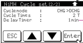
Während der Lade- / Entladevorgänge erwärmt sich der Akku. Unter dem Punkt „Delay Timer“ kann eine Wartezeit eingestellt werden, um den Akku abkühlen zu lassen, bevor der nächste Schritt im Zyklus gestartet wird. Wir empfehlen Wartezeiten von mindestens 30 Minuten.
