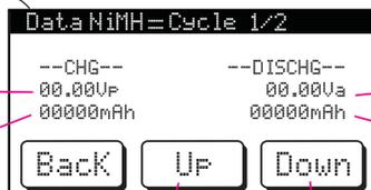
Ladeschlussspannung des Akkus
