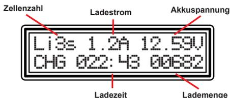
6. Wenn der Ladevorgang abgeschlossen ist, ertönt ein akustisches Signal. Ein vorzeitiges Abbrechen des Ladevorgangs, kann durch Drücken der AKKUTYP/STOP Taste erreicht werden.
