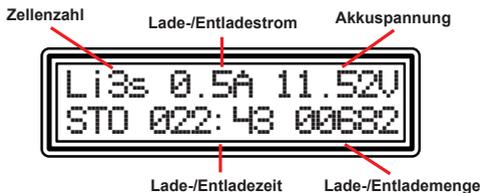
4. Wenn der Vorgang abgeschlossen ist, ertönt ein akustisches Signal. Ein vorzeitiges Abbrechen des Vorgangs, kann durch Drücken der AKKUTYP/STOP Taste erreicht werden.
