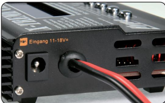
Der X-Treme Charger X6 ist serienmäßig mit kontaktsicheren Krokodilklemmen ausgestattet. Alternativ verfügt das Gerät über eine Steckerbuchse, über den der X6 mit Spannung versorgt werden kann.
