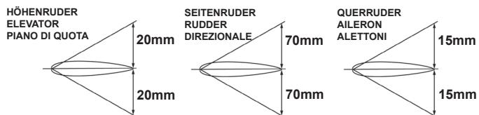
Die Werte werden an der Hinterkante der Ruder gemessen. Geben Sie auf alle Funktionen 45% Exponential-Anteil. / The values are measured at the rear edge of the flaps. Set 45% Exponential on all functions. / si misura al bordo posteriore delle parti mobili. Date 45% di esponenziale su entrambi funzioni.
