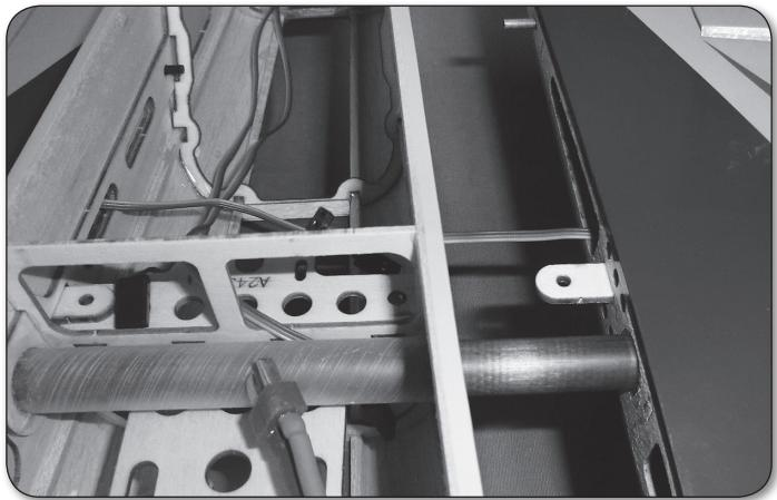
Nehmen Sie die beiden M3 Schrauben zur Hand und sichern Sie die Tragflächen am Rumf, wie dargestellt. / Take the two M3 screws at hand and secure the wings as shown. / Con le due viti M3 fissare l'ala sulla fusoliera come mostrato.
