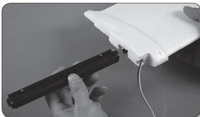
Überprüfen Sie nochmals die korrekte Einbaurichtung des Tragflächenverbinder. / Check once again the correct direction of the wing joiner! / Controllare che la baionetta sia infilata nel verso giusto!
