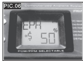
2. Kanal 5 aus Servo Reverse setzen und die EPA-Werte auf +/- 50% setzen. Der Schalter für Kanal 5 wählt den Betriebsmodus. Anschließend den Sender wieder ausschalten. / Reverse channel 5 and and set EPA values to +/-50%. / 2° Impostare canale 5 su servo reverse e regolare il valore EPA a +/- 50%. L'interruttore del canale 5 seleziona il modo d'utilizzo. Ora spegnere nuovamente la trasmittente.
