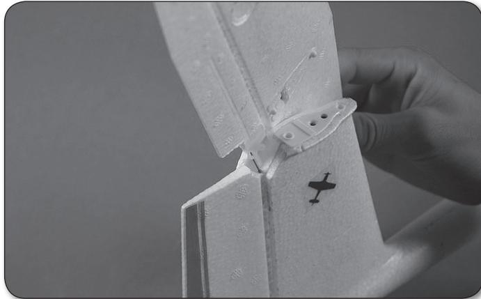
Setzen Sie das Höhenleitwerk auf den Rumpf und verschrauben Sie es wie dargestellt. / Put the horizontal stabilizer on the fuselage as show and tighten the screw securely. / Montate gli impennaggi sulla fusoliera e avvitate come mostrato in foto.
