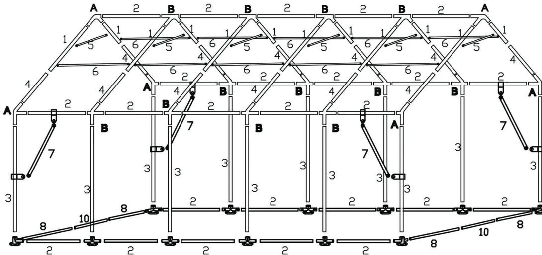
**1 / Choisissez un endroit plat pour le montage de votre tente. Commencez par monter la structure de toit en assemblant les tubes #1, #2, et #4 dans les jonctions A et B.**
