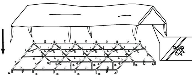
**5 / Inclinez la structure sur un côté afin de monter les pieds dans les différentes jonctions A et B. Puis procédez de la même manière de l'autre côté.**
