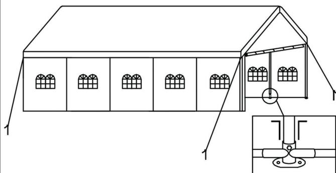
8 / Posez les bâches latérales sur la structure au moyen d'élastiques, et joignez les côtés entre eux avec les fermetures éclair.
