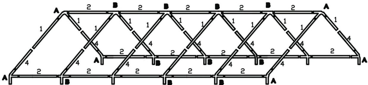
**2 / Placez les renforts de la structure de toit en assemblant les tubes #5 sur les tubes #1 avec les vis M6X60. Puis positionnez les tubes #6 avec les vis M6X16.**
