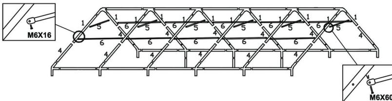
**3 / Assemblez les tubes #3 avec les platines de pieds, les fixer avec les vis écrous.**
